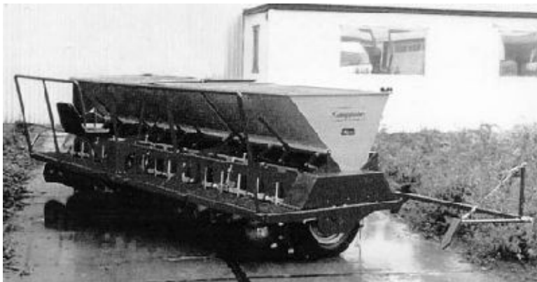
Figuur 2-11: Een uienplantmachine met een werkbreedte van 4,5 meter
